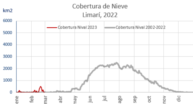
Figura N5. Serie de la cobertura porcentual de nieve en la provincia de Limarí calculada diariamente por medio de datos satelitales MODIS.
